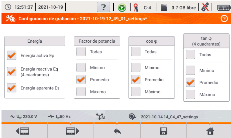
Fig. 11. Configuración de registro - energías y factores de potencia.
