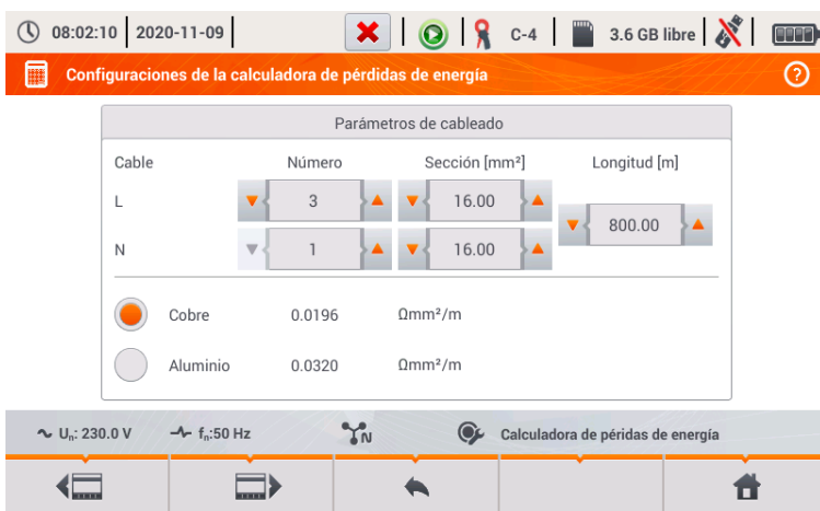
Fig. 50 Análisis de las pérdidas de energía - pantalla de configuración 1
