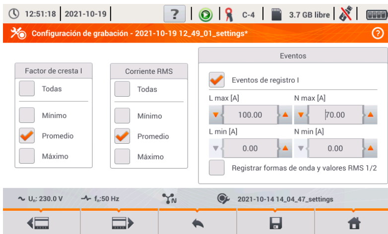
Fig. 9. Configuración de registro - parámetros de corriente.
